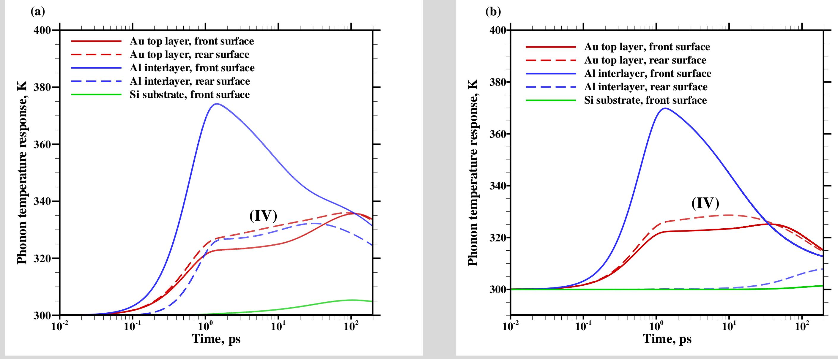
Fig. 5. Phonon temperature response, (a) 10-nm Au/50-nm Al/100-nm Si, (b) 10-nm Au/200-nm Al/100-nm Si.
